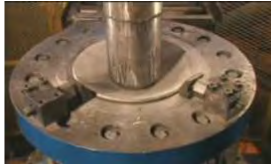
Compression entre poinçon et matrice
