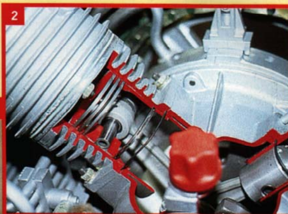
2. Eclaté du cylindre du premier étage, avec piston et sa segmentation.
