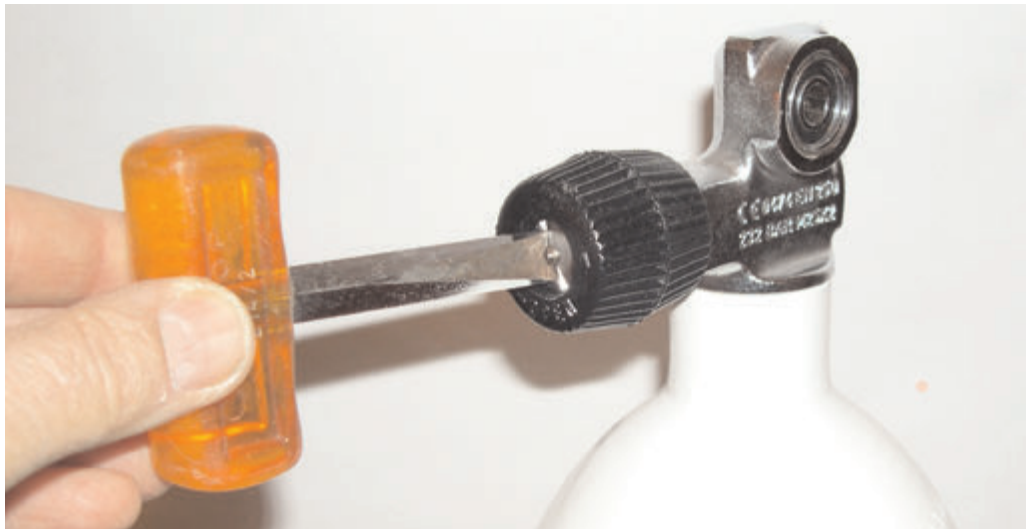
A l'aide du tournevis fendu, dévisser l'écrou qui retient le volant de conservation
