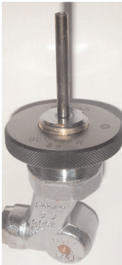
La bague lisse "n'entre pas" entre, le filetage est hors norme
