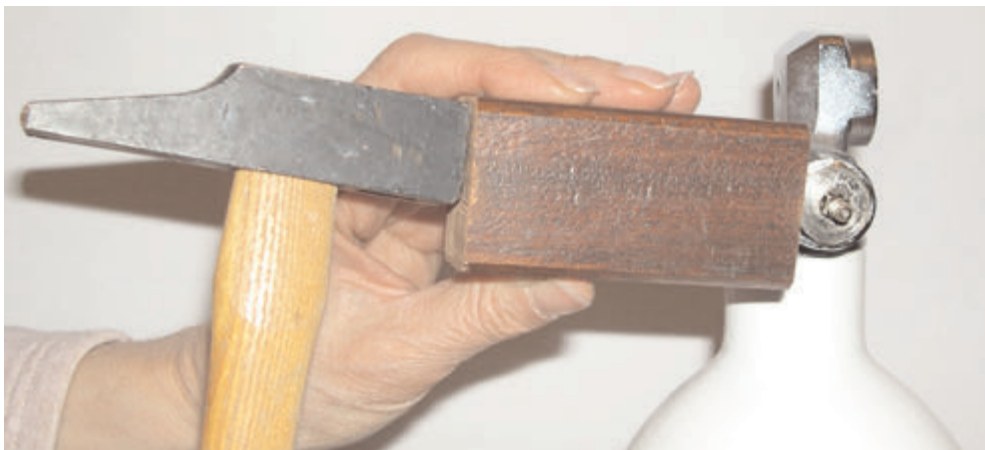
A l'aide du maillet et du martyr, frapper modérément sur la partie qui était recouverte par le volant de conservation, jusqu'à débloquer le robinet. Ne jamais frapper sur une partie creuse du robinet. Le corps du robinet est en laiton, alliage malléable qui serait endommagé de façon irréversible. Une autre solution consiste à enlever l'opercule et à visser un levier dans le filetage DIN.
