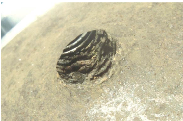
La corrosion galvanique du filetage conduit à la mise au rebut de la bouteille
