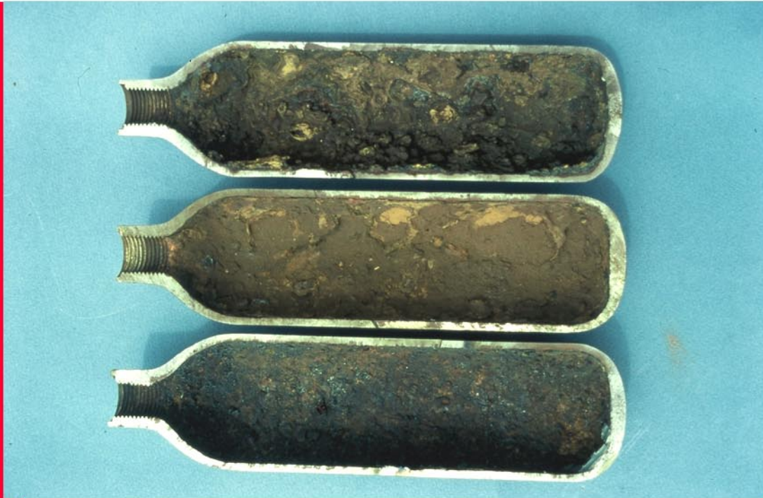
Corrosion généralisée dans des bouteilles de gilets de stabilisation. ayant contenu de l'eau de mer
