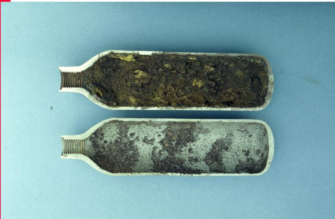
Corrosion généralisée dans une bouteille de gilet de stabilisation. avant et après grenailage
