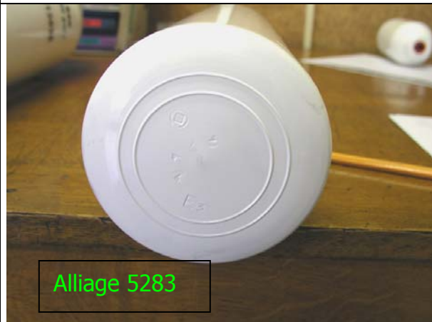
Figure 2 : aspect des cercles concentriques sur les bouteilles à « fond bombé »
