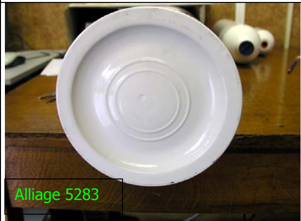
Figure 3 : aspect des cercles concentriques sur les bouteilles à « fond plat »
