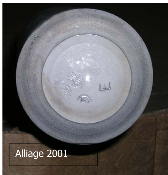
Figure 4 : Bouteille en alliage 2001 aspect du fond comportant un cercle
