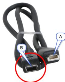
3. Insérez l'extrémité libre du câble (le connecteur « **A** ») dans le port USB de la calculatrice.
