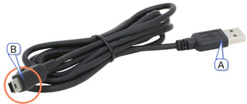
3. Insérez l'extrémité libre du câble (le connecteur « A ») dans un port USB de l'ordinateur.
