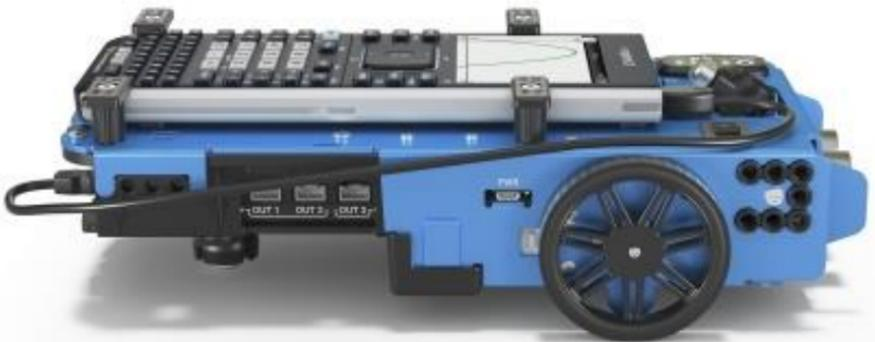
**Remarque :** Avec le Hub inséré, accédez à trois ports pour le contrôle des modules de sortie.
