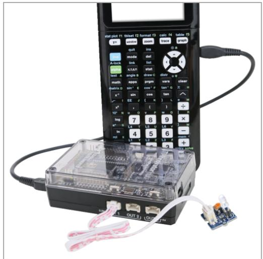
La Hub chaîne de commande "CONNECT LED 1 TO BB1" informe le Hub qu'un module à DEL est branché sur le port **OUT 1** sur le Hub. Après avoir envoyé cette commande, le code vient s'adresser à la DEL avec la référence "LED 1". La commande CONNECT est requise uniquement pour les modules E/S et les composants de la platine d'essais. Elle n'est pas nécessaire avec les composants intégrés, tels que le haut-parleur intégré.
