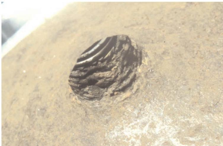
Fig.7 - .La corrosion galvanique du filetage conduit à la mise au rebut de la bouteille
