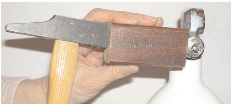
Fig.3 - Démontage du robinet à l'aide d'un marteau et d'un martyr en bois
