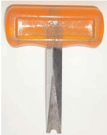
Fig.1 - Tournevis fendu pour démonter le volant du robinet de conservation et éventuellement le levier de réserve
