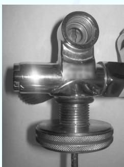
Robinet conforme à la bague fileté n'entre pas. L'état des filets est satisfaisant.
