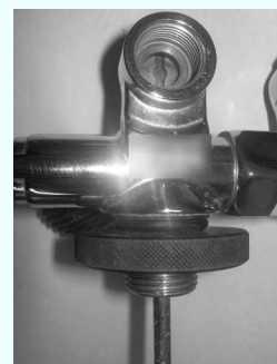
Le même robinet s'avère être non conforme à la bague lisse n'entre pas. Son diamètre est insuffisant. Il sera rebuté.
