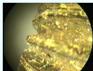
Filets d'un robinet attaqué par la corrosion et rejeté à la bague lisse "n'entre pas"
