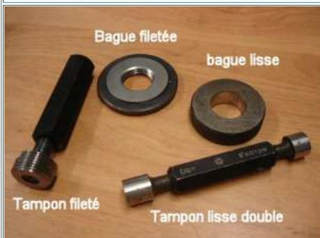
Le filetage de la bouteille est passé au taraud. Son état et son diamètre sont contrôlés au tampon lisse et fileté.
