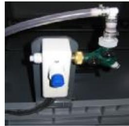
La centrale de dilution permet automatiquement, dès l'ouverture du robinet d'eau, de doser le volume de produit d'entretien **AbyssNaut** à la concentration optimale d'utilisation.
