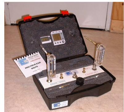
**Plus précis :** Tous les paramètres nécessaires au contrôle sont identifiés (température, hygrométrie, mesure simultanée et lisible des temps de mesure sur un seul et même appareil, débits d'air facilement réglés et identifiés, fiche de contrôle simple à rédiger)
