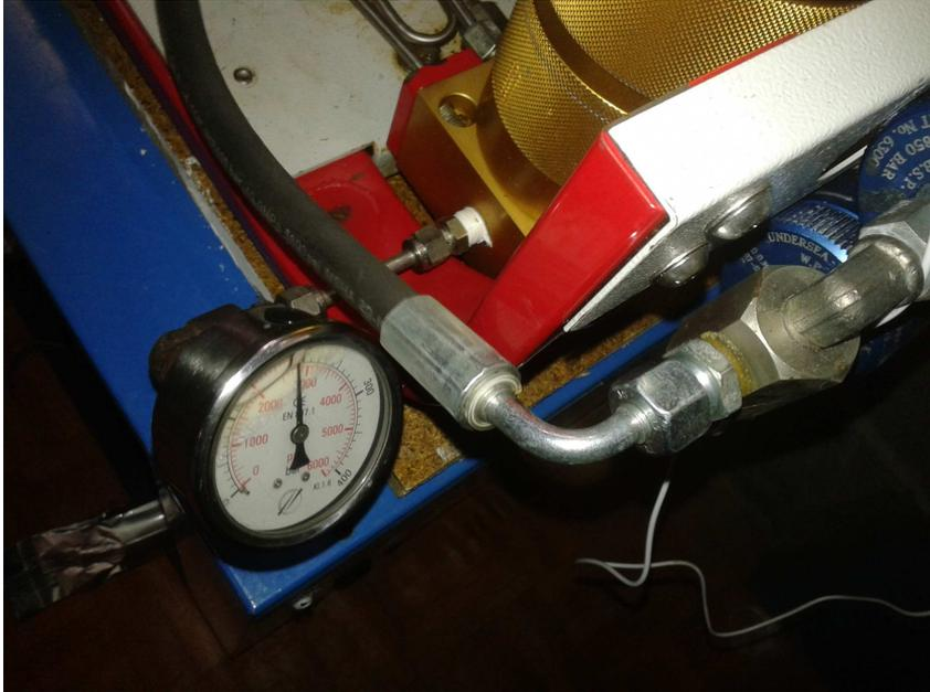
**Assurez-vous que la pression interne dépasse 120 bar, avant que l'air ne puisse sortir des flexibles de chargement (purge étrier ouverte).**
