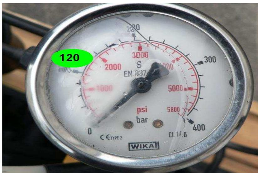
On peut ajuster la valeur lue sur le mano fixé sur le décanseur HP en utilisant la molette située sous le déverseur, en vissant la pression monte, en dévissant la pression baisse.
