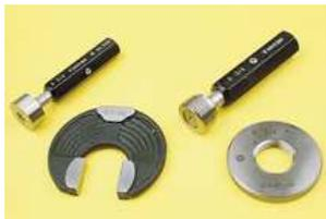
Tampons et bagues lisses et filetés servant à la vérification des filetages
