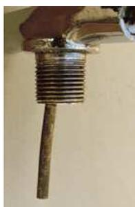
Or il n'en est rien, le diamètre extérieur du M 25 x 2 ISO, légèrement supérieur au diamètre intérieur du 3/4 gaz, est tout juste suffisant pour créer l'illusion d'un montage mécanique, mais n'a aucune résistance. En outre ce montage nécessite un forçage des trois ou quatre derniers tours, du fait de la différence de pas, ce qui engendre la destruction d'une partie des filets du robinet constitués de laiton, matériau moins dur que l'acier de la bouteille.
