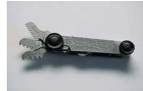
La jauge de filetage permet de déterminer le pas du filetage et de lever le doute.
