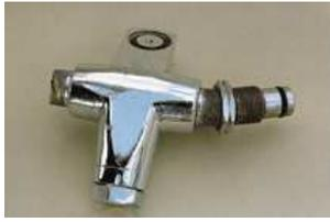
Pièce centrale d'une robinetterie de bi-bouteille tordue d'un côté et cisaillée de l'autre par la violence de l'explosion
