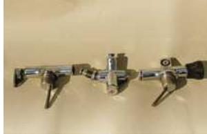
Robinetterie de bi 25 X 2 montée sur des bouteilles 3/4 gaz, après explosion
