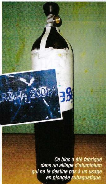
Ce bloc a été fabriqué dans un alliage d'aluminium qui ne le destine pas à un usage en plongée subaquatique.
