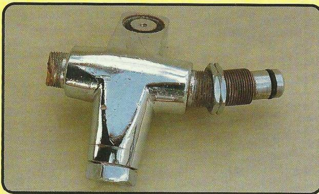
*Pièce centrale d'une robinetterie de bi-bouteille tordue d'un côté et cisailée de l'autre par la violence de l'explosion.*
