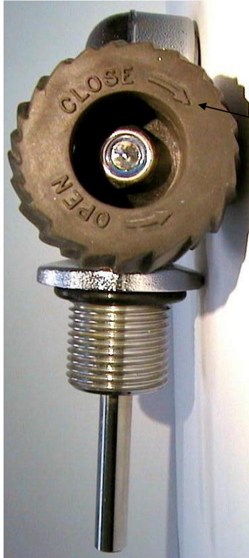
le robinet se ferme dans le sens des aiguilles d'une montre lorsqu'on le regarde en face
