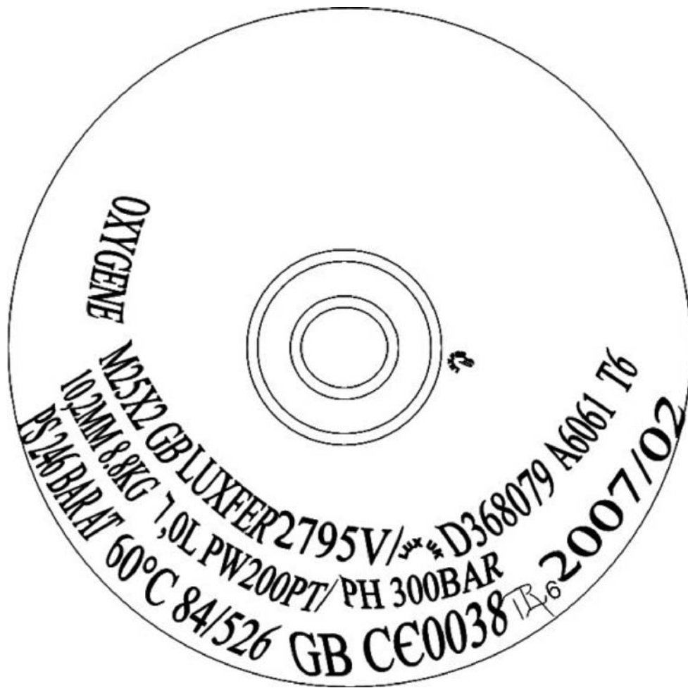
Figure 5 - Marquage des bouteilles en Europe
