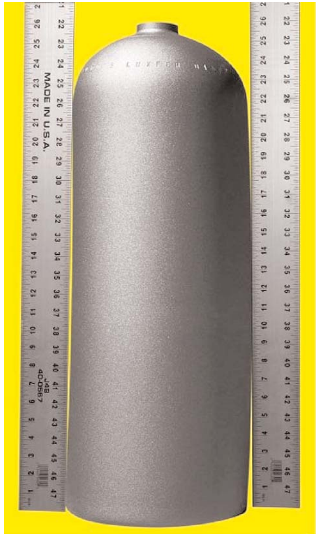
FIGURE 11: Arcage, flambage ou bananage d'une bouteille.
