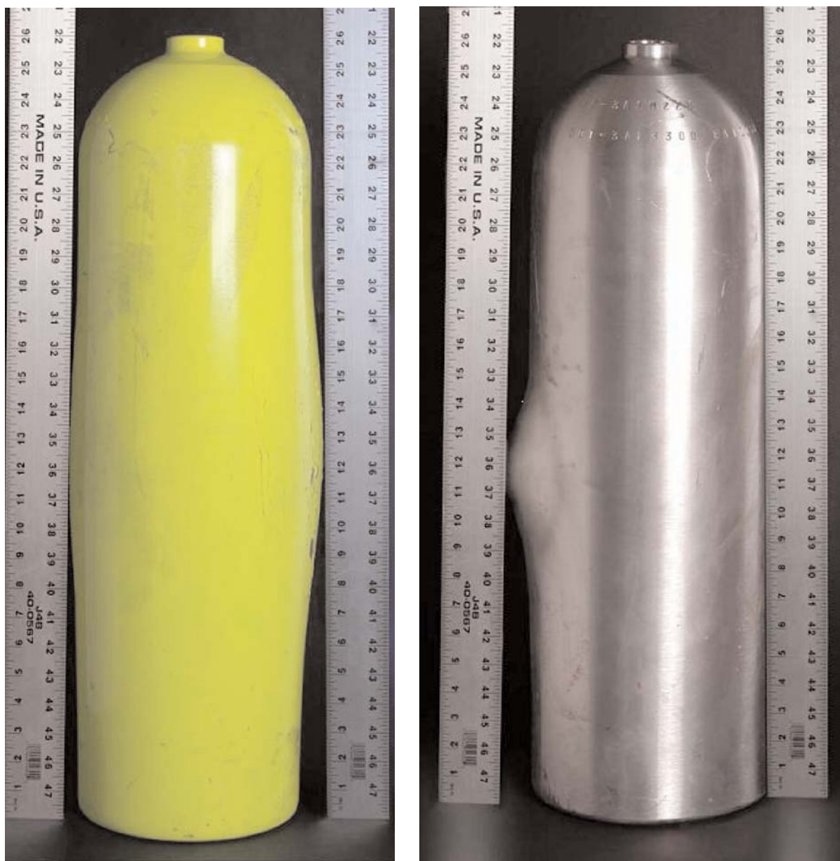
FIGURE 12 : saillie sur une bouteille
