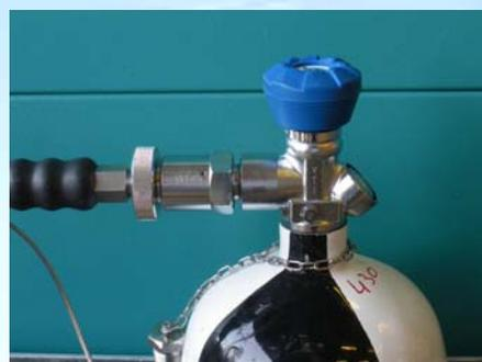
Une fois le bouchon retiré, la bouteille est raccordée au banc de gonflage. Le robinet peut désormais être ouvert par une personne compétente.
